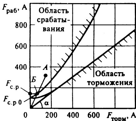
Рисунок 1.3. К определению чувствительности дифференциальной защиты с реле типа ДЗТ-11 при наличии торможения.
