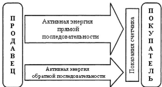
Рисунок 8 – Диаграмма обмена некачественной энергией при несимметричной системе генерирования и симметричной нагрузке [10]
