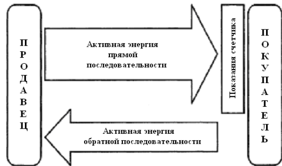
Рисунок 7 – Диаграмма обмена некачественной энергией при симметричной системе генерирования и несимметричной нагрузке [10]
